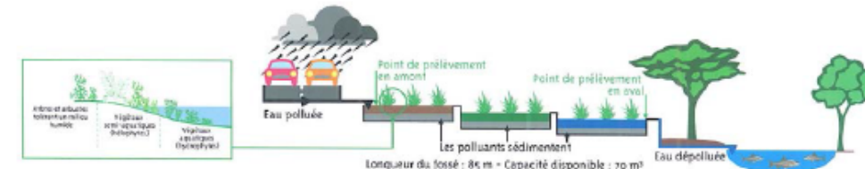
Schéma de principe et photos de la lagune de la place de la Colombie : La place de Colombie à Paris 16 ème se situant sur le boulevard des Maréchaux, ne pouvait bénéficier d'un raccordement à l'égout pour ses eaux de ruissellement. Aussi ces eaux se rejetaient-elles directement dans un lac des lacs du bois de Boulogne, milieu aquatique très sensible. La Commune a décidé en 1996 d'insérer entre la place de Colombie et le lac inférieure une lagune afin d'épurer ces eaux de voirie. (Photo : Mairie de Paris et IGN)
