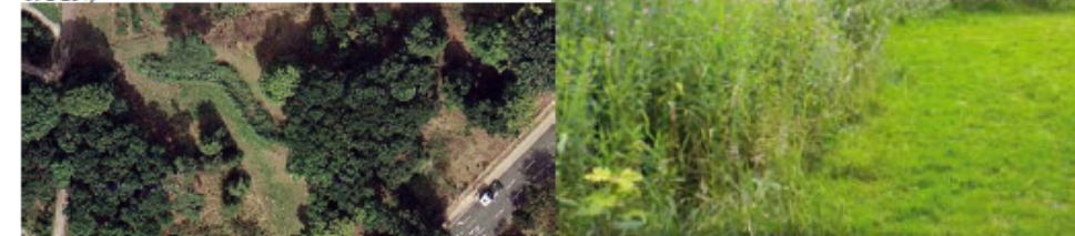
Schéma de principe et photos de la lagune de la place de la Colombie : La place de Colombie à Paris 16 ème se situant sur le boulevard des Maréchaux, ne pouvait bénéficier d'un raccordement à l'égout pour ses eaux de ruissellement. Aussi ces eaux se rejetaient-elles directement dans un lac des lacs du bois de Boulogne, milieu aquatique très sensible. La Commune a décidé en 1996 d'insérer entre la place de Colombie et le lac inférieure une lagune afin d'épurer ces eaux de voirie. (Photo : Mairie de Paris et IGN)
