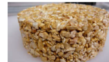
Revêtement de gravilles/liant synthétique avec perméabilité minimale de 10 -3 m/s (procédé PERMEAWAY, photo site MCK Environnement)
